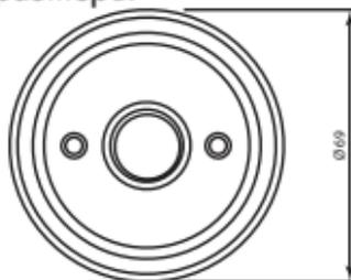
2.3 Расстояние между крепежными отверстиями 38 мм
